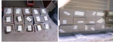
Şekil 2. Numune alınması ve havuz kürü
