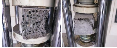
Şekil 4. Basınç Deneylerinden kesitler
