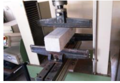
Şekil 3. Eğilme Deneylerinden bir kesit
