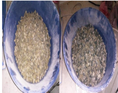
Şekil 1. Üretilen 1. tip ve 2. tip prizmatik agregalar
